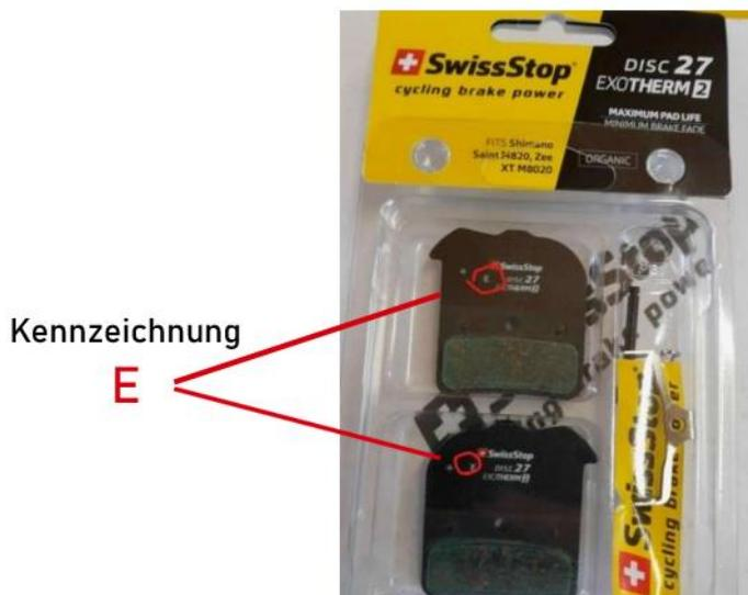
Wenn Sie SwissStop Disc 27 EXOTherm 2 Bremsbeläge mit der Produktionscode-Markierung **E** haben, wenden Sie sich bitte an den Kaufort oder Ihren Fahrradhändler, um den Austausch der betroffenen Pads zu veranlassen. Alle Disc 27 EXOTherm 2 Scheibenbremsbeläge mit Produktionscode-Markierung **E**, ob neu oder gebraucht, müssen zum Austausch an einen SwissStop-Händler zurückgegeben werden.
