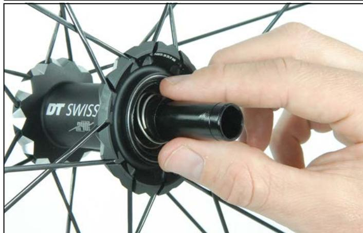
5. Beide Zahnscheiben auf (Abb.3.1, S.22/11) die Achse schieben.
