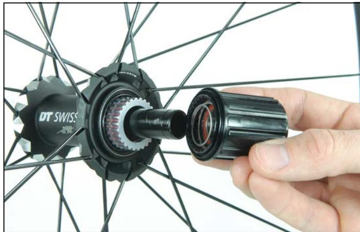
8. Endanschlag (Abb.3.1, S.22/13) auf die Achse aufstecken.
