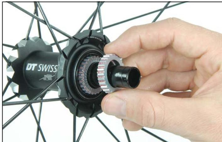
6. Zweite Feder mit dem grossen Durchmesser voran in den Rotor stecken.
