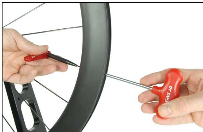
2. Speiche, deren Kreuzung an der Nabe zur Laufradmitte hin verläuft (B), zum einfacheren ausfädeln entflechten.
