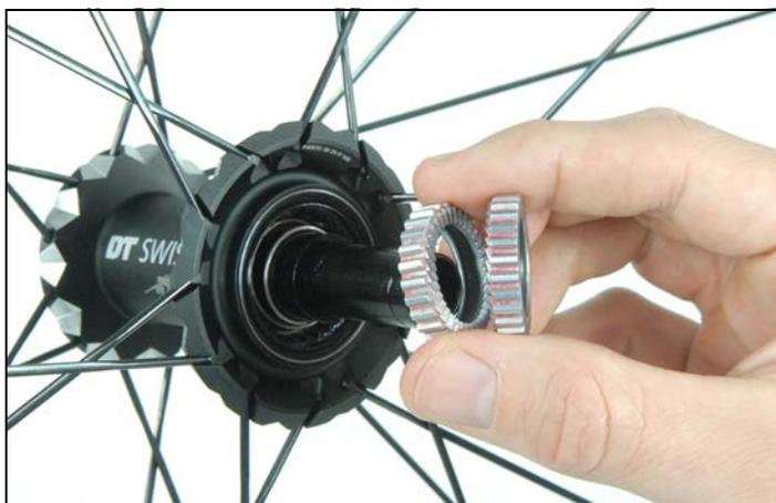
6. Hülse (Abb.3.1, S.22/9) und zweite Feder (Abb.3.1, S.22/10) abnehmen.
