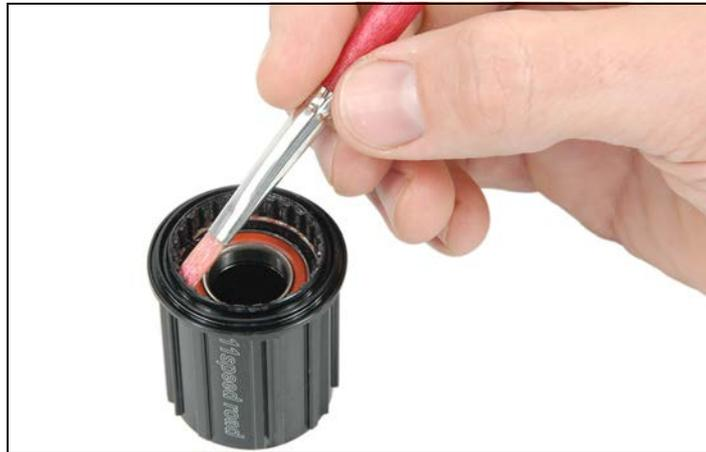
3. Verzahnung des Gewinderings (Abb.3.1, S.22/7) mit DT Swiss Spezialfett fetten.
