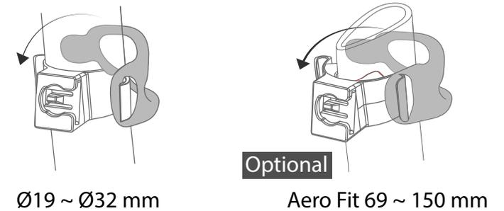
1. Sobald die Leuchte und Halterung horizontal ausgerichtet sind, installiere die Leuchte an der Halterung, drehe diese in eine 90-Grad Position und befestige sie.
