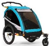
**Walking-Set (ab 2019 bereits im Lieferumfang enthalten):** Das einzelne Buggy-Rad bleibt fix an der Deichsel befestigt. Möchte oder muss man sein Fahrrad stehen lassen, wird das kleine Rad nach unten geklappt, und die Reise kann ganz einfach zu Fuß fortgesetzt werden.
